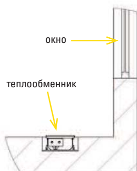
Рис. 2: Конвектор с теплообменником, установленным по направлению «от окна», как основной источник тепловой энергии
