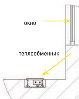
Рис. 3: Конвектор с теплообменником, установленным по направлению «к окну», как дополнительный источник тепловой энергии.
