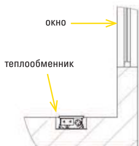
Рис. 2: Конвектор с теплообменником, установленным по направлению «от окна», как основной источник тепловой энергии
