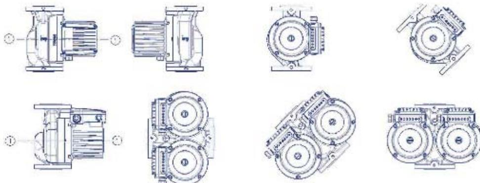
Abbildung 2: Korrekte Position der Pumpe beim Einbau
