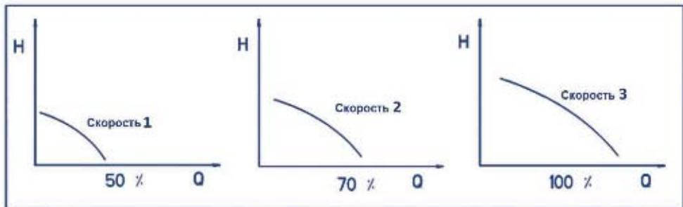
Рисунок 9. Характеристики насоса при работе на разных скоростях
