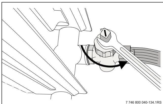
Рис. 13 Слив воды из отопительной системы при опасности замерзания
