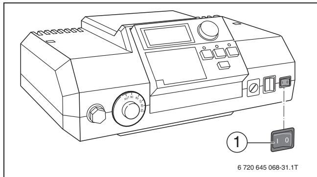
Рис. 11 Выключение отопительной установки (Logamatic 2000)
