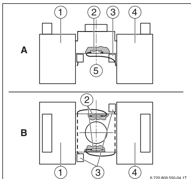
Рис. 4 Датчики температуры дымовых газов в сдвоенном котле
