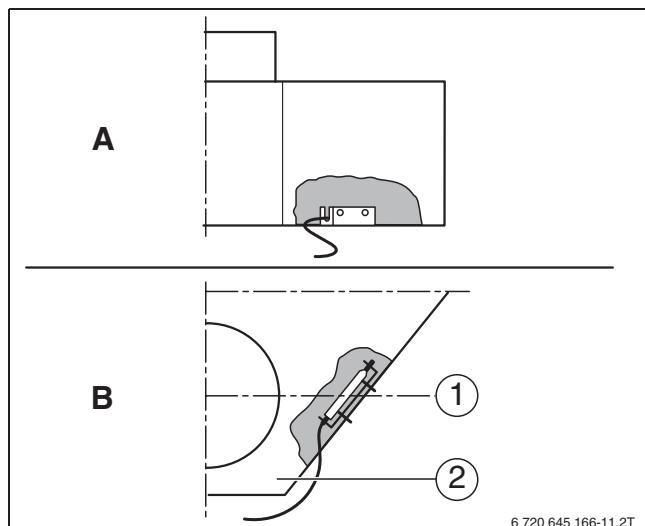
Рис. 3 Датчик температуры дымовых газов котла
