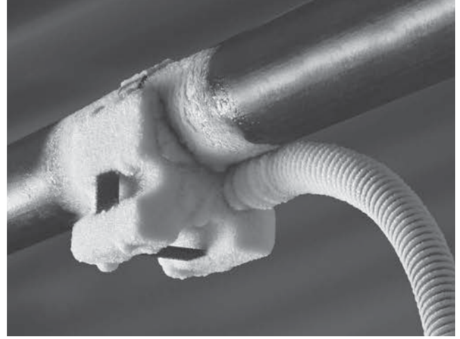
Şekil 9 – Borunun Üzerinde Donan Dondurma Kafası
