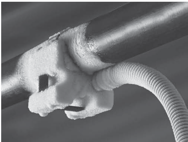
9. ábra – A fagyasztófej a csőhöz fagyott
