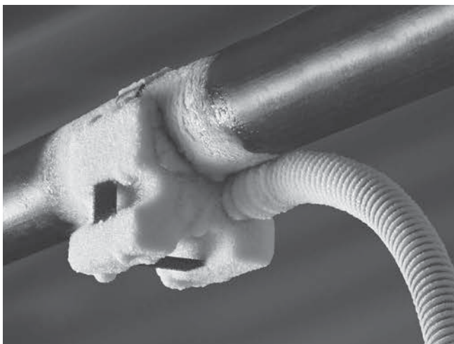
Slika 9 – Zaleđena glava za zamrzavanje na cevi
