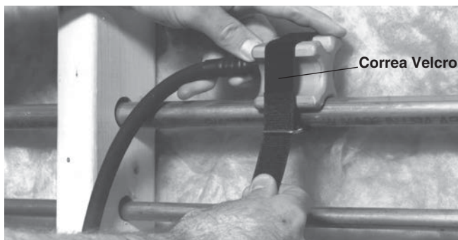
Figura 5 – Fijación del cabezal de congelación con la correa Velcro
