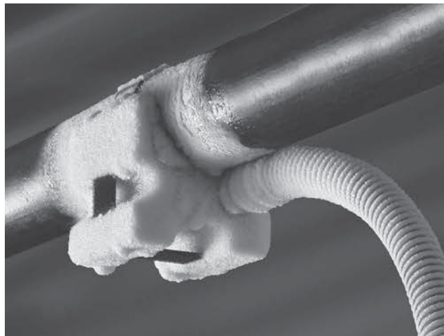
Obrázek 9 – Mrazicí hlava přimrzlá k trubce
