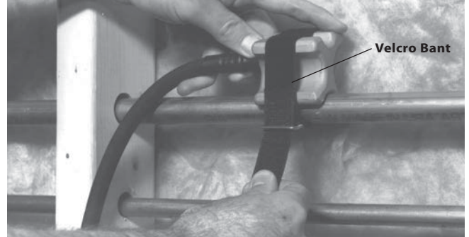
Şekil 5 – Dondurma Kafasının Velcro Bantla Uygulanması
