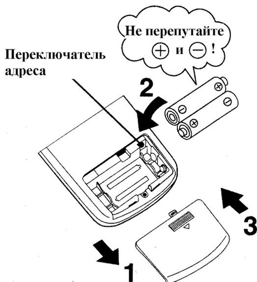
**1.** Нажмите на участок задней крышки, обозначенный символом
