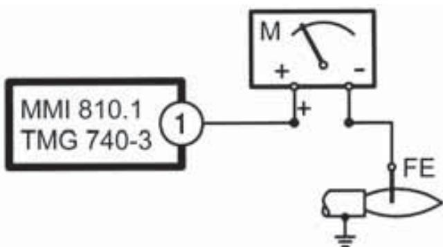
Рис. 24: Подключение измерителей
