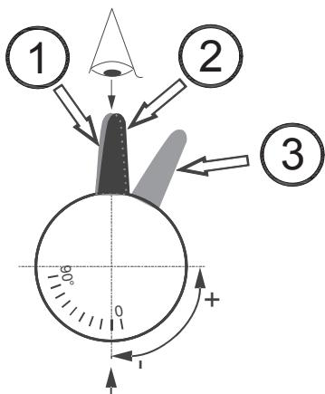
Рис. 6: Привод воздушной заслонки 1-я ступень
