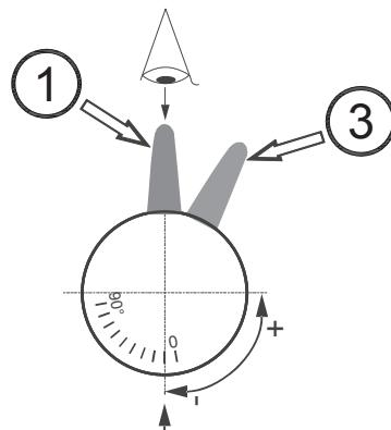
Рис. 8: Привод газового клапана на 1-ой ступени.
