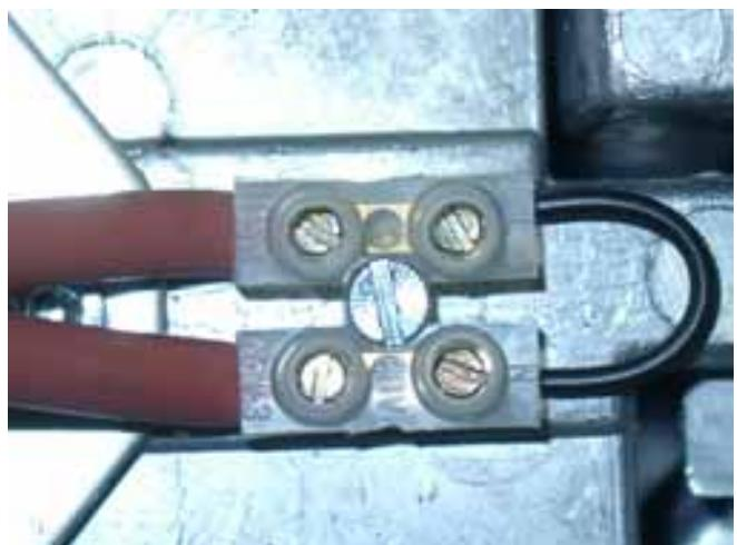
Рис. 26: Перемычка для измерения ионизационного тока
