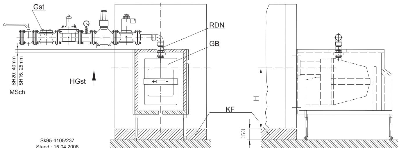
Рис. 12: Оснащение шумопоглощающим кожухом Logatop GZ3 und GZ4
