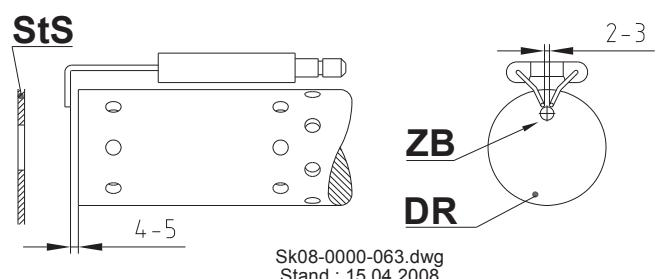
Рис. 17: Расположение запальных электродов Logatop GZ4 Сжиженный газ
