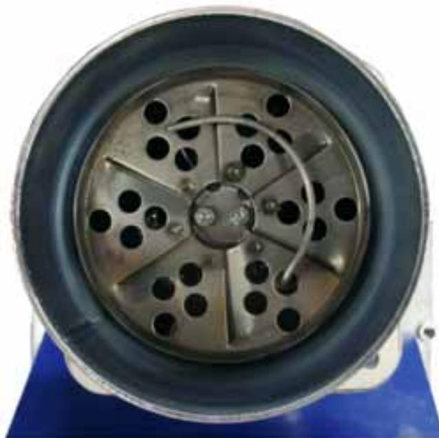
Рис. 25: Расположение электрода ионизации Logatop GZ2
