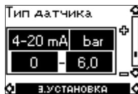
Параметры датчика должны устанавливаться только при регулируемом режиме.
