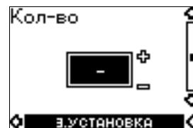
В этом окне меню на дисплее можно присваивать насосу адрес в виде номера в диапазоне от 1 до 64 или, изменять присвоенный ранее номер. В случае установления связи через ШИНУ каждому насосу обязательно должен присваиваться индивидуальный номер.
