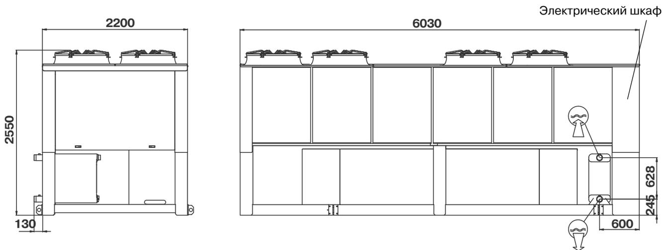
**Примечание:** патрубки для подсоединения труб водяного контура с наружной резьбой 3".
