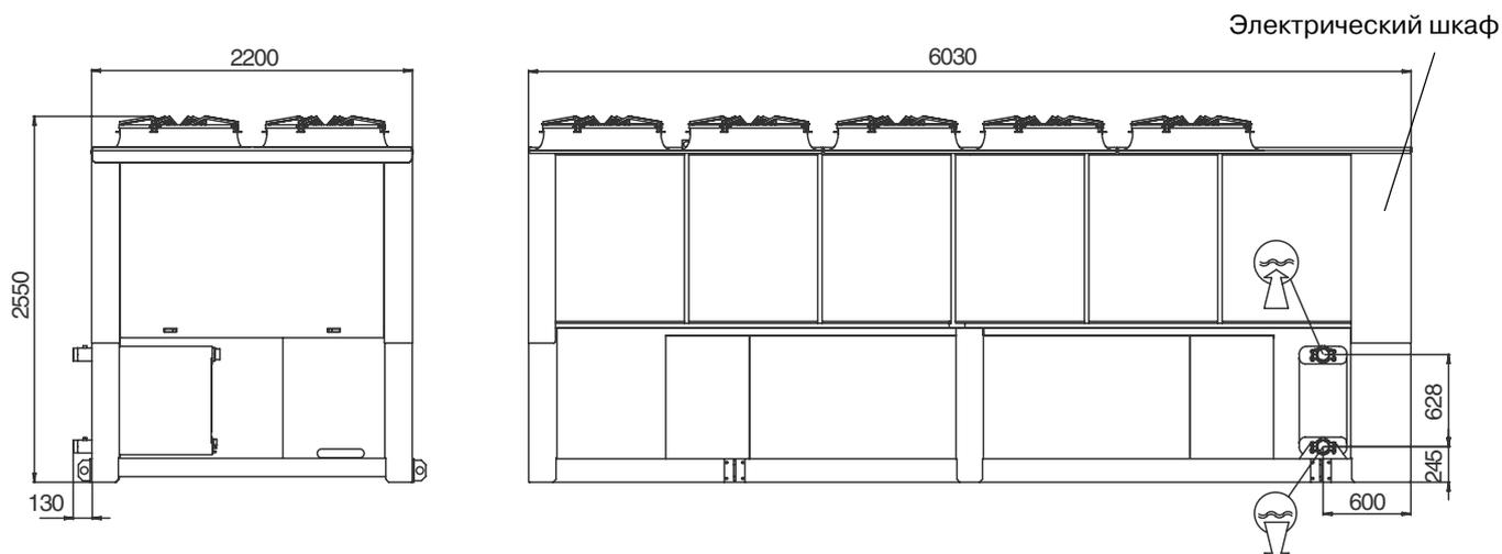
**Примечание:** патрубки для подсоединения труб водяного контура с наружной резьбой 3".
