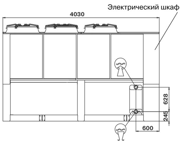
**Примечание:** патрубки для подсоединения труб водяного контура с наружной резьбой 3".
