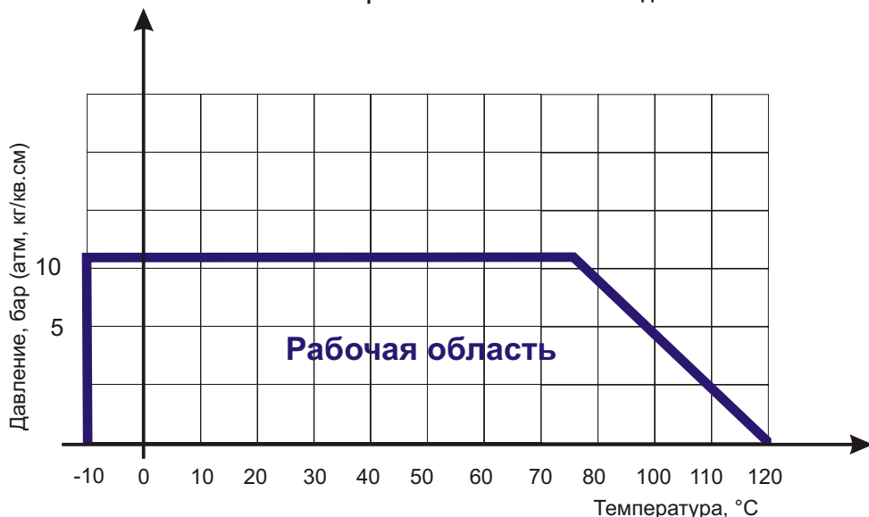
Диаграмма Давление / Температура для задвижки клиновой ABRA-A40-10G с обрезиненным клином и невыедным штоком DN 200-600 PN 10:
