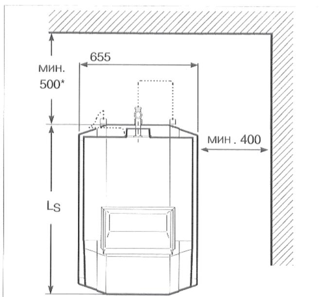
Рис. 2: Вид сверху \*) При применении шумоглушителя 700 мм.
