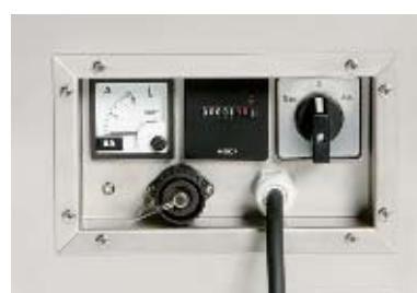
Рис. 10. Панель управления AD 240...400 B.
