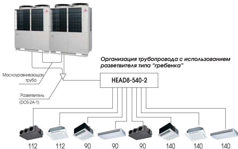
Разветвитель трубопровода наружных блоков
