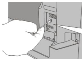
2 Удалите загрязнения линзы с помощью сухой ватного валика.
