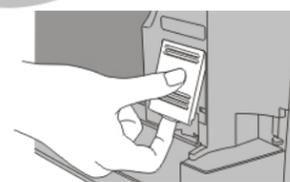
1 Снимите крышку с датчика пыли
