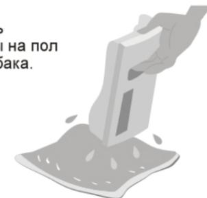
Вылейте воду из бака и поддона, прежде чем она замерзнет. (Работа прибора при замерзшей воде может вызвать неполадки.)
