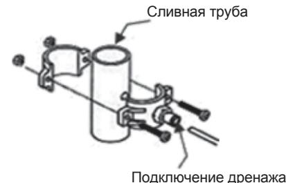
Черную полиэтиленовую трубку, идущую от системы обратного осмоса, необходимо присоединить к адаптеру быстроразъемного соединения (см. раздел «Соединительные трубы»).
