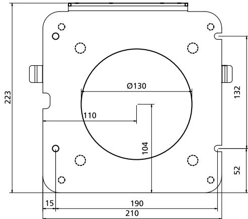
Монтажная панель горелки, вид со стороны горелки по направлению к котлу. Крепеж четырьмя винтами M6.
