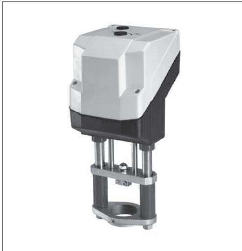
Электроприводы AME 85 и AME 86 предназначены для управления регулирующими клапанами VFS2  $D_y = 65\text{--}100$  мм, а также клапанами VF2, VF3  $D_y = 125\text{--}150$  мм. Электропривод автоматически подстраивается под крайние положения штока клапана.
