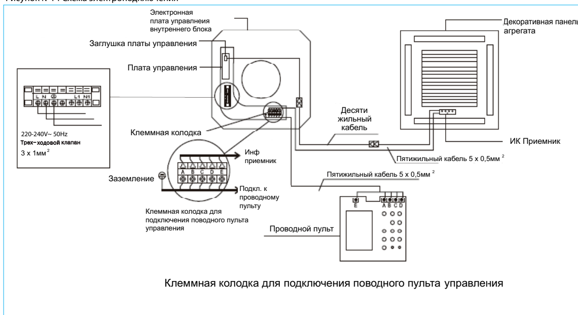
Рисунок №14 Схема электроподключения
