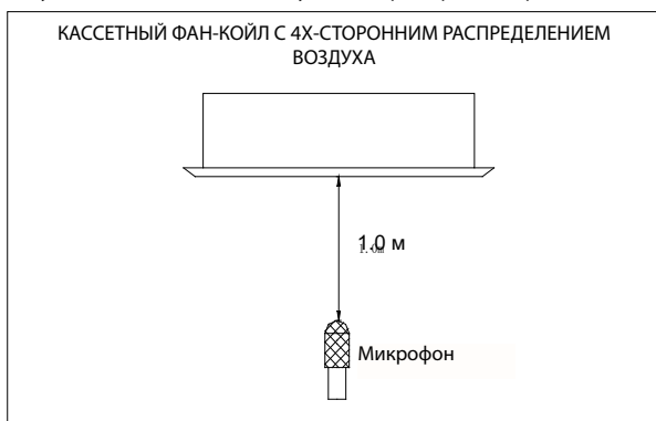
Рисунок №6 Схема испытаний шумовых характеристик агрегатов
