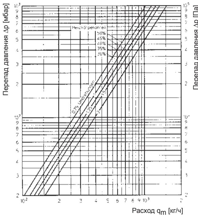
Двухтрубный режим (байпасный винт закрыт)
