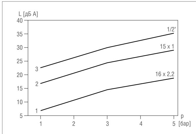
Рис. 19-3 Результат испытания Института им. Фраунхофера: Сравнительный анализ шумоизолирующих характеристик материалов труб
