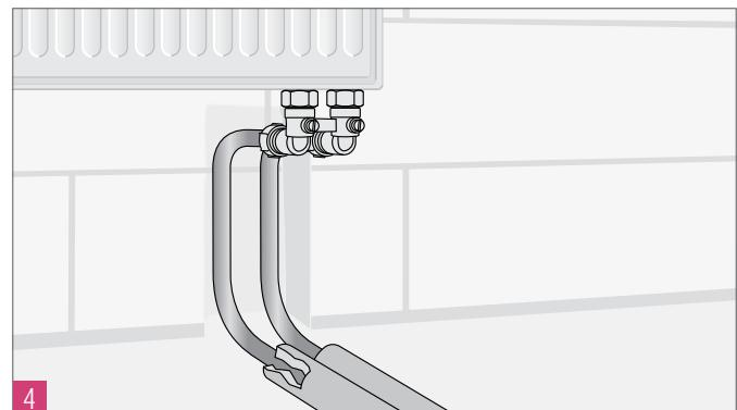
Рис. 11-8 Прямое подключение с помощью труб Rautitan stabil к отопительным приборам со встроенным вентилем
