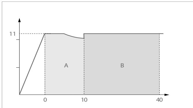
Рис. 7-1 Диаграмма гидравлического испытания для труб RAUTITAN stabil
