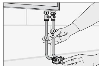
Рис. 13-7 Г-образные присоединительные трубы, вставленные в фиксирующий уголок
