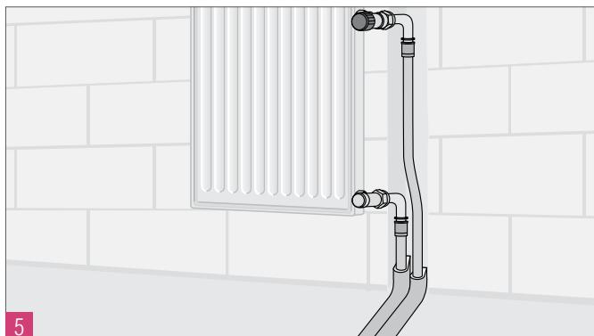
Рис. 11-10 Подключение к запорно-регулировочной арматуре радиатора при помощи Г-образных присоединительных трубок
