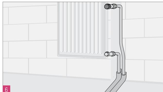
Рис. 11-12 Подключение к запорно-регулировочной арматуре радиатора с помощью переходника с наружной резьбой Rautitan MX
