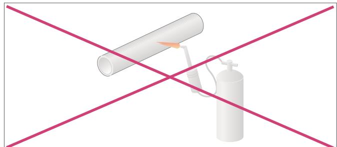
Рис. 17-2 Не допускается превышение температуры нагрева
