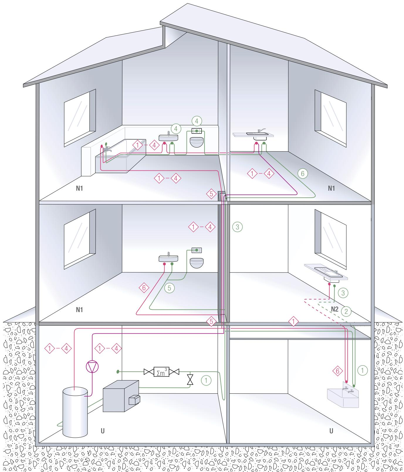
Рис. 18-3 Монтажные ситуации при изоляции трубопроводов
