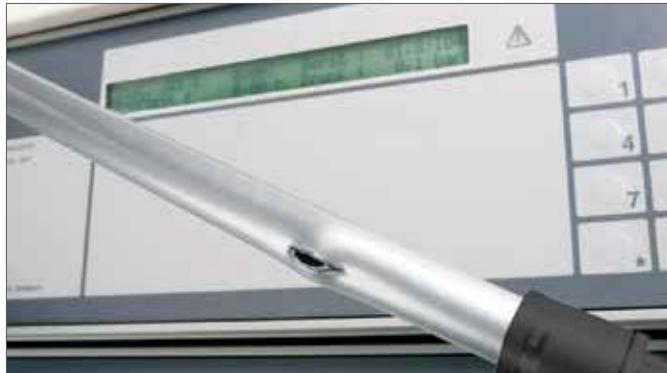
Рис. 3-1 Результаты испытания прочности на разрыв давлением . Испытуемый продукт – универсальная труба RAUTITAN flex
