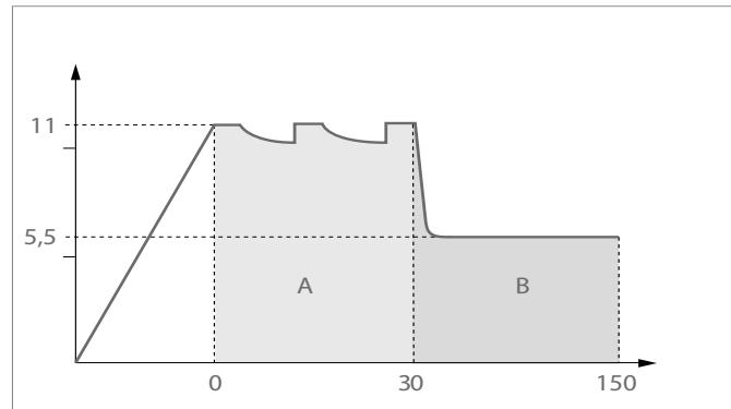
Рис. 7-2 Диаграмма гидравлического испытания для труб RAUTITAN flex, RAUTITAN his
