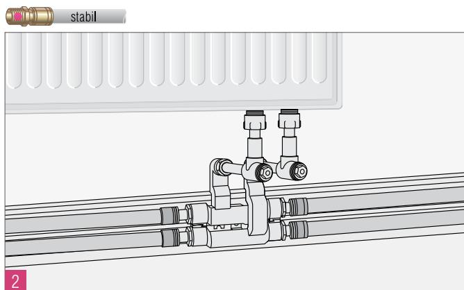
Рис. 16-6 Подключение отопительного прибора с помощью крестовины SL-Rautitan
