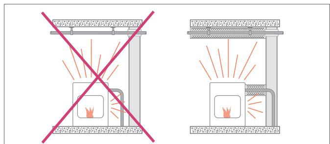
Рис. 17-3 Защита от перегрева
