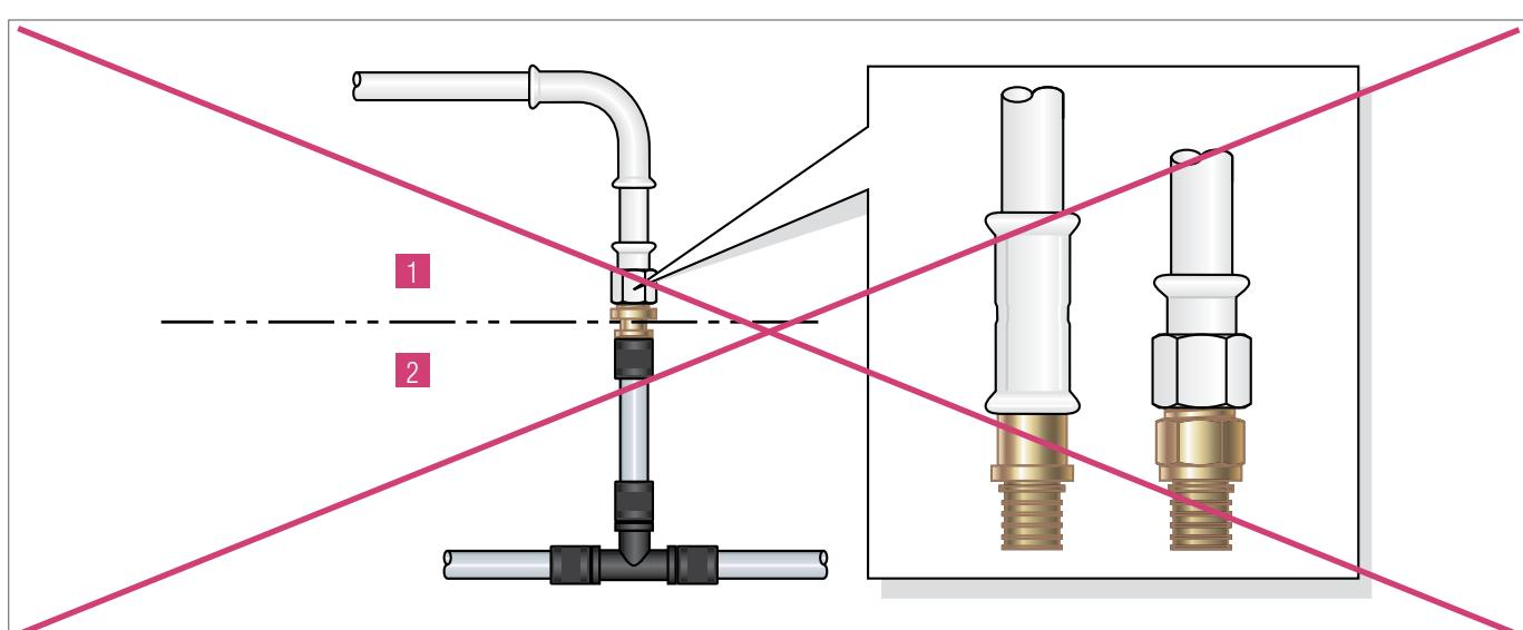
Рис. 6-20 Случай неверного непосредственного подключения системы из нержавеющей стали к системе RAUTITAN для Ø до 32 или резьбе до R1"/Rp1" из нержавеющей стали (пример)
