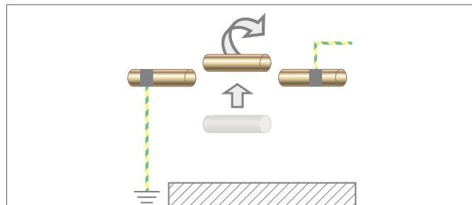
Рис. 17-12 Выравнивание электрических потенциалов при замене труб
