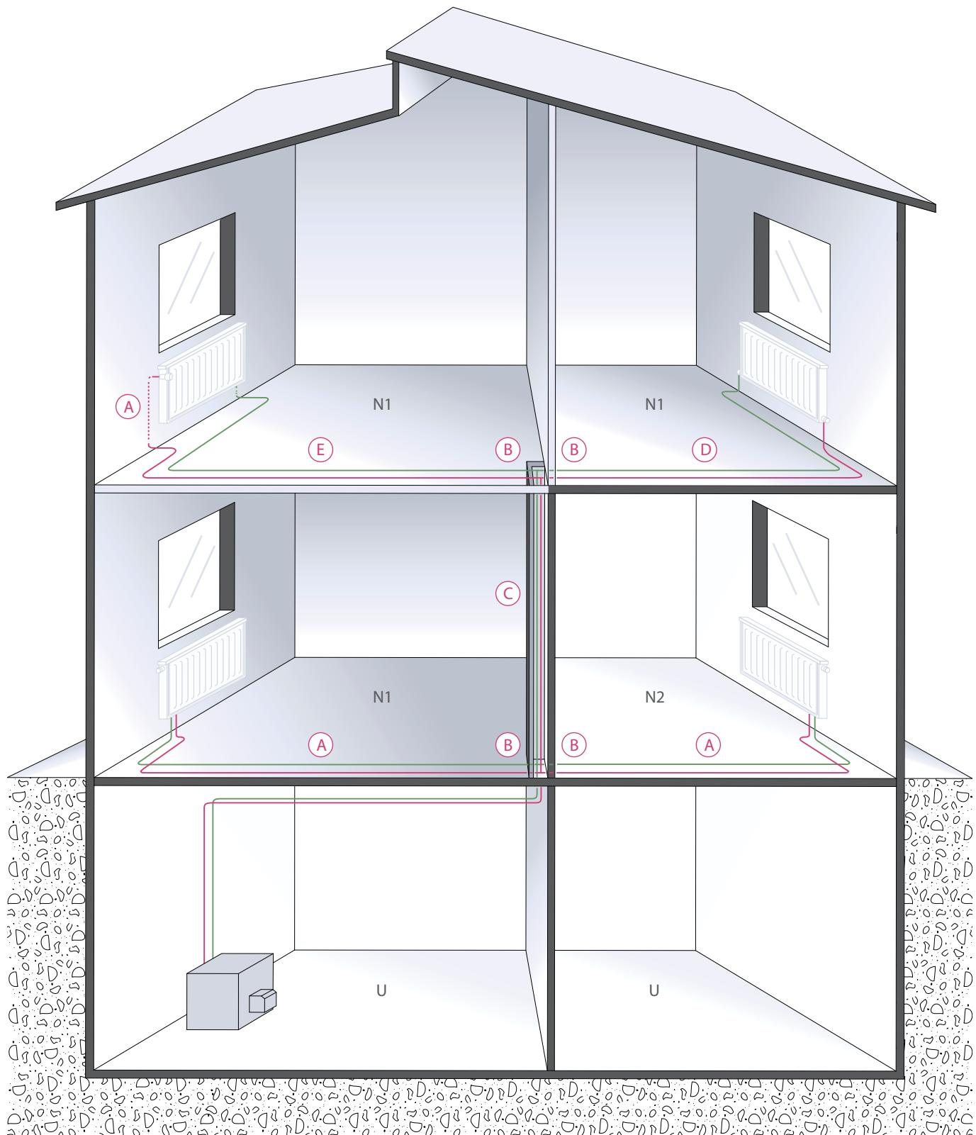
Рис. 18-4 Монтажные ситуации при изоляции трубопроводов
