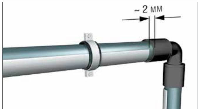
Рис.13-2 Фиксирующий желоб должен не доходить до надвижной гильзы на 2 мм
