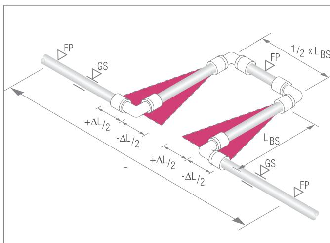
Рис. 16-2 П-образный компенсатор
