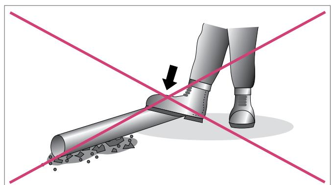
Рис. 4-2 Не клать трубы на поверхность из материала с острыми краями
