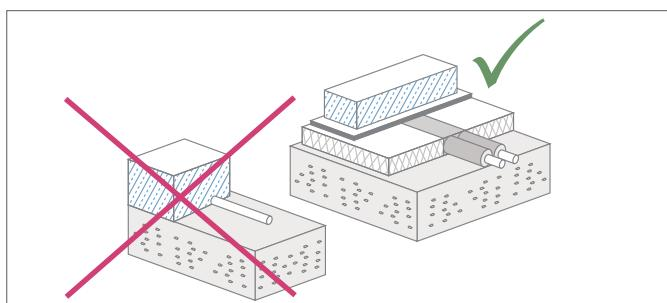
Рис. 17-1 Укладка труб по перекрытию в чистоте
