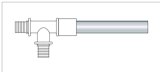
Рис. 10-11 Готовое соединение
