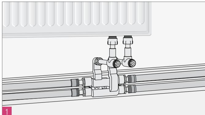
Рис. 16-4 Подключение отопительного прибора с помощью крестовины SL-Rautitan 16-12-16
