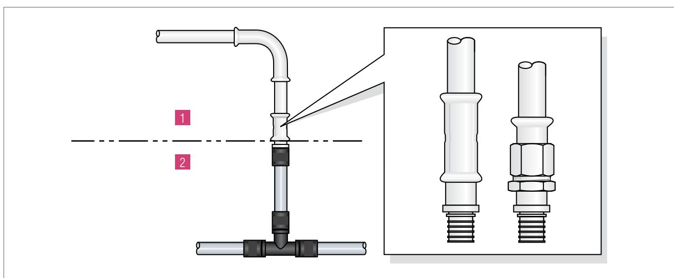
Рис. 6-19 Непосредственное подключение системы из нержавеющей стали к системе RAUTITAN для Ø до 32 или резьбе до R1"/Rp1" из нержавеющей стали (пример)
