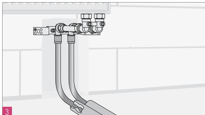
Рис. 11-6 Подключение отопительного прибора со встроенным вентилем при помощи монтажного комплекта Rehau с настенным угольником
