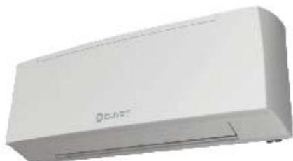
**ELFOFSpace Wall<sup>2</sup>** представляет собой серию фанкойлов для открытой установки, разработанную для быстрого и простого монтажа в пространстве над дверью или на средней высоте на стене. Эти блоки имеют исключительно низкий уровень шума и регулируемое направление потока воздуха и поставляются со всеми компонентами, необходимыми для монтажа и запуска (монтажная плата, трехходовой клапан, инфракрасный пульт управления).
