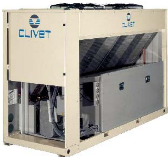
Компрессорно-конденсаторные блоки воздушного охлаждения серии **MSAT** рассчитаны на наружную установку и спроектированы для обеспечения наибольшего КПД при небольших размерах. Используются герметичные компрессоры типа Scroll. Они оснащены новейшей системой контроля рабочего режима на микропроцессоре, позволяющей регулировать и оптимизировать все функции блока с повышением уровня энергоэффективности.
