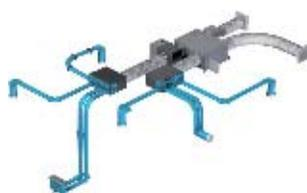
ELFOFresh Air моноблочная вентиляционная система с термодинамической рекуперацией, предназначенная для внутренней установки, способная удовлетворить 80% тепловой потребности здания.
