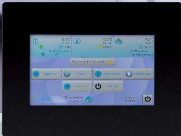
Контроль блоков для частного сектора, обогрев, кондиционирование, ГВС и системы вентиляции. ELFOControl<sup>2</sup> это “мозг” всей системы, объединяющий все компоненты в единую сеть.
