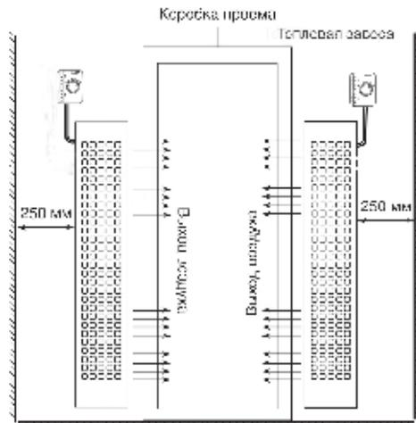
В задней стенке корпуса завесы имеются пазы для установки завесы (см. рисунок ниже). За эти пазы завеса навешивается на предварительно смонтированный в стену крепеж. В качестве крепежа рекомендуются шурупы или болты с диаметром шляпки от 9 до 11 мм. Установочные размеры завес приведены в таблице ниже.
