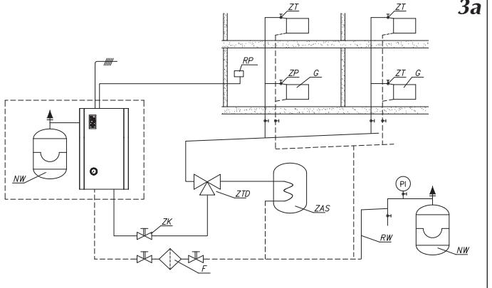
Фильтр следует установить на возврате из отопительной проводки. Фильтр должен быть установлен горизонтально с обращенной вниз камерой магнитного вкладыша, направление протока должно соответствовать стрелке на корпусе фильтра.
