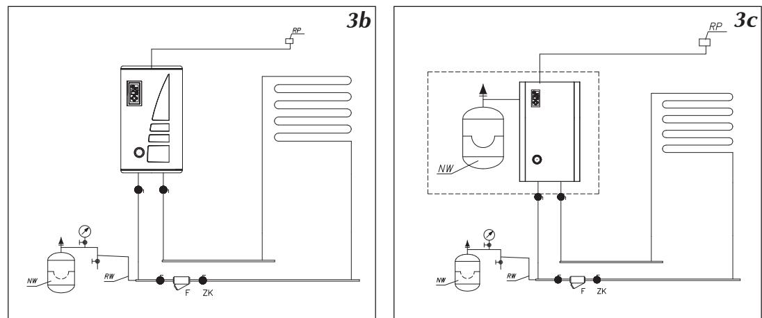
Котел EKCO.L1Nz оснащен мембранным расширительным баком (объем 6 литров, давление 1,5 бар). Установленный в котле расширительный бак достаточно для следующих объемов отопительных проводок при указанных температурах теплоносителя и давления в отопительной системе.
