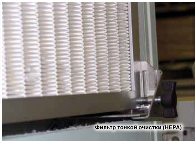
Карманный фильтр, закрепленный при помощи прижимной планки
