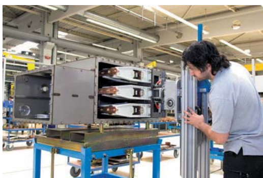
Монтаж силового выключателя
