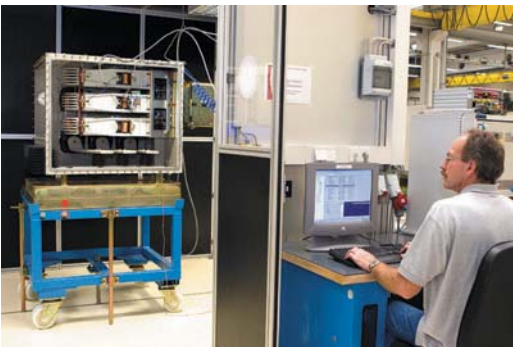
Испытательный стенд для измерения скорости включения / отключения коммутационных аппаратов
