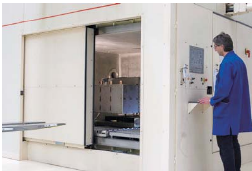
Испытание на утечку элегаза для ячейки
