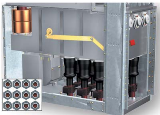
Кабельный ввод с внутренним конусом до 35 кВ, 4 подключения на фазу, размер 2 (800 А) или размер 3 (1250 А) с ТН на вводе
