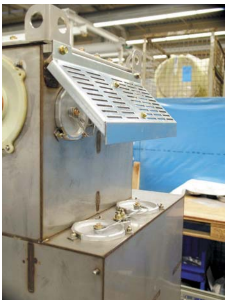
Клапан для сброса избыточного давления на примере GHA с одинарной системой сборных шин
