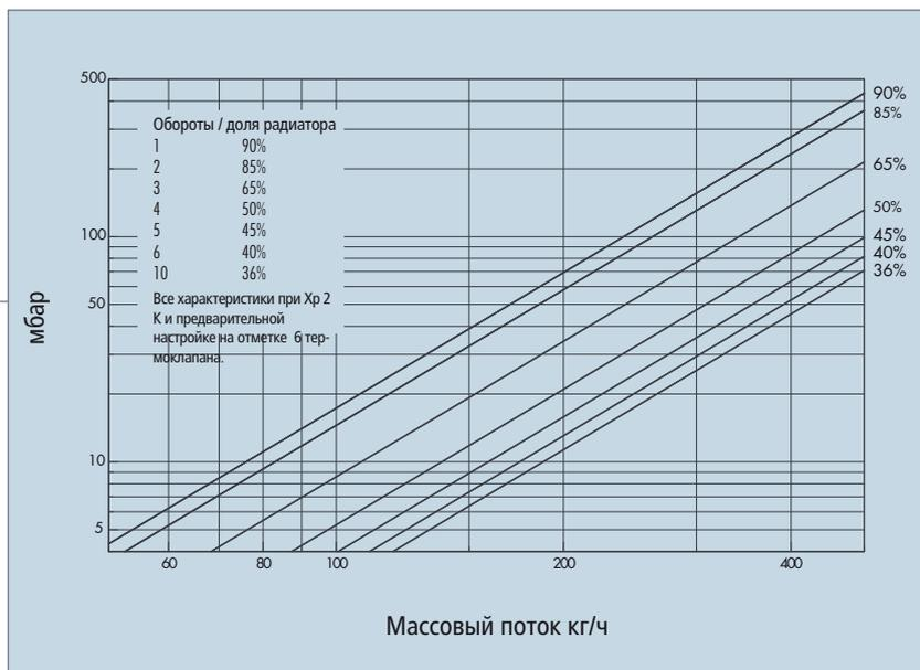
Данные действительны для арматуры без нагревательных приборов и потерь давления при подключении
