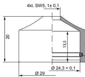
Уплотнение в виде кольца 24 x 1,5, материал NBR, твёрдость по Шору 70
