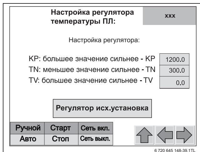
Рис. 29 Экран „Настройка регулятора температуры подающей линии“
