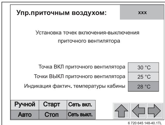
Рис. 27 Экран настройки „Управление приточным воздухом“
