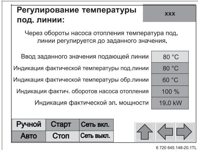
Рис. 28 Экран настройки „Регулирование температуры подающей линии“
