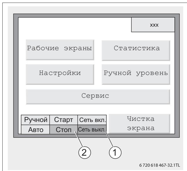
Рис. 11 Выключение установки
