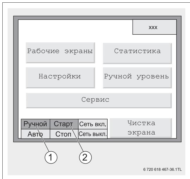
Рис. 9 Включение установки
