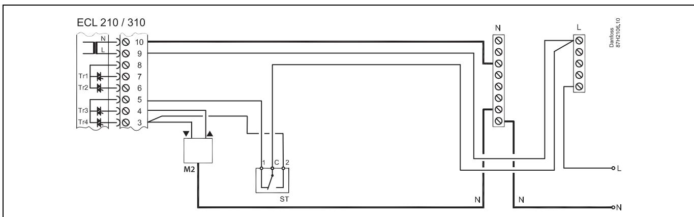
**С термостатом безопасности, одноступенчатое закрытие:**
