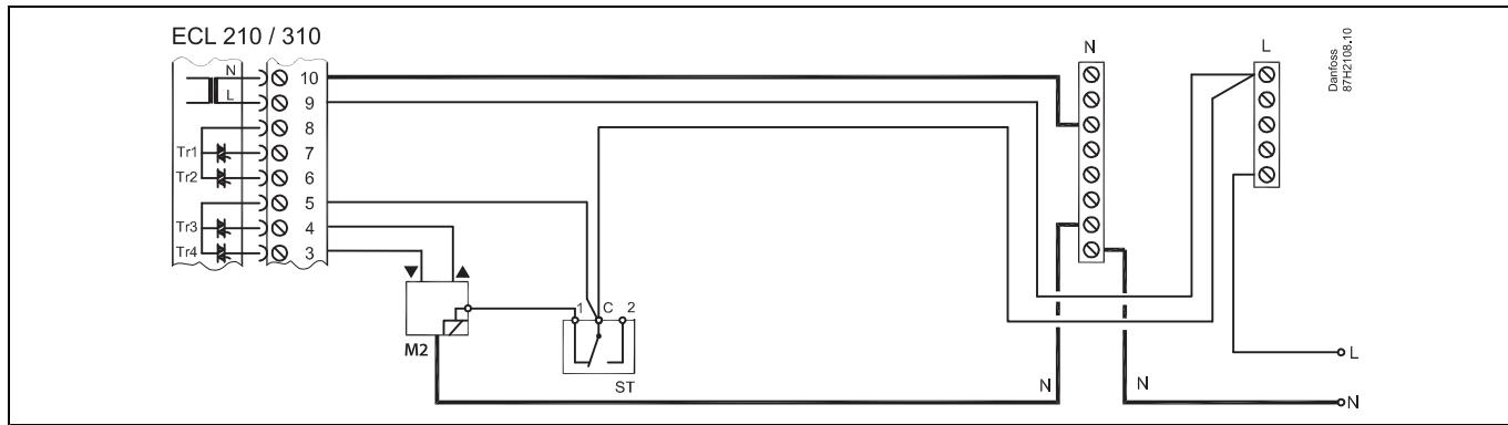
**С термостатом безопасности, двухступенчатое закрытие:**
