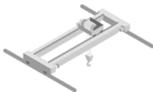
Привод мостового крана с архитектурой CANopen: - Подъем: Altivar 71 - Перемещение крана: Altivar 312 - Перемещение тележки: Altivar 312
