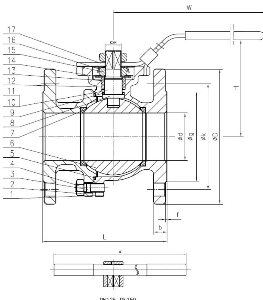
**Условное графическое изображение шарового крана из нержавеющей стали на чертежах и схемах :**
