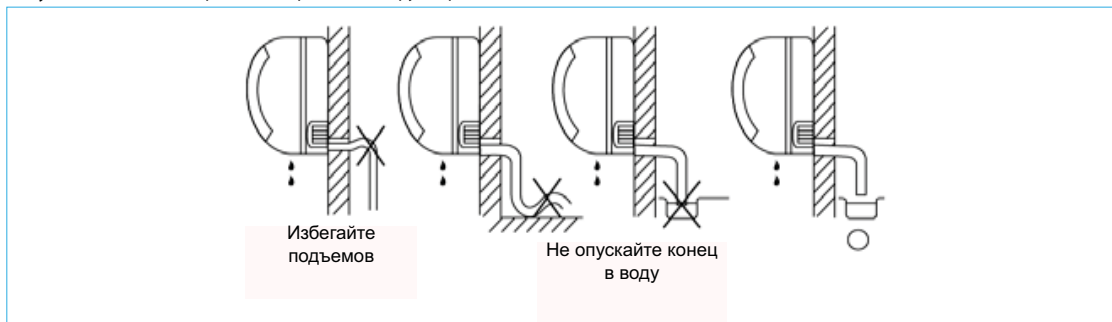
Рисунок №50 Способ прокладки дренажного трубопровода
