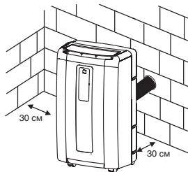
Расстояние от кондиционера до стен и других предметов должно быть не менее 30 см. Запрещается использовать кондиционер в помещениях с высокой влажностью (прачечных, ванных комнатах и т.п.). При установке прибора обеспечьте свободный доступ к розетке сети электропитания. Электромонтаж кондиционера следует выполнять в соответствии с Правилами устройства электроустановок (ПУЭ) и местными нормативными документами.
