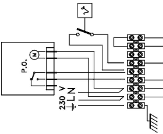
Подключение электрического питания, программируемого таймера системы отопления и термостата температуры в помещении. Контакты и программируемого таймера и термостата температуры в помещении работают под напряжением  $V=230$ Вольт переменный ток.
