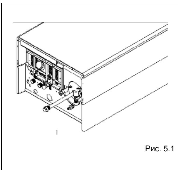
Если снять фланец, можно будет проверить чистоту бойлера внутри, а также состояние магниевого анода.
