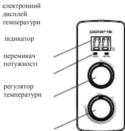
1. За допомогою перемикача потужності встановіть необхідну потужність (1300Вт /2000Вт). Від вибору потужності залежить швидкість (час) нагрівання води до заданої температури. При вмиканні перемикача потужності в позицію «1» прилад працює з потужністю 1300Вт. При вмиканні перемикача потужності в позицію «2», прилад працює з потужністю 2000Вт. Індикаторна лампочка, що світиться, означає нагрівання води.
