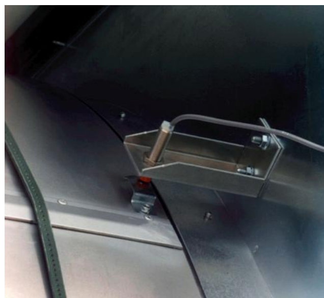
Датчик контроля вращения ротора
