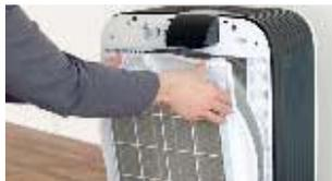
3. Выдвиньте поддон и извлеките барабан с увлажняющим фильтром.
