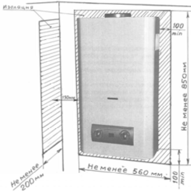
3.2.9 Аппарат навешивается на закрепленные в стене кронштейны (прилагаются к изделию), с помощью монтажных отверстий на каркасе. Монтажные отверстия аппарата показаны на рис.3.
