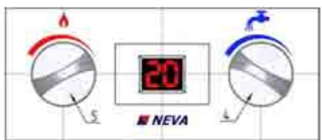
**Рисунок 9 Положение ручек перед включением аппарата**
