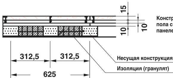
Конструкция «сухого» теплого пола с основанием из двойных панелей «Fermacell» 2 x 10 мм
