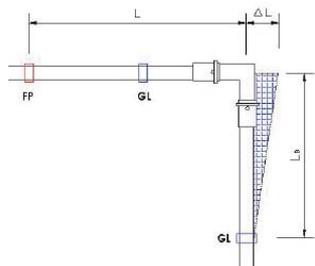
Компенсация теплового удлинения с помощью Г-образного компенсатора при изменении направления трубопровода. Значение компенсационного плеча в соответствии с формулой или по диаграмме
