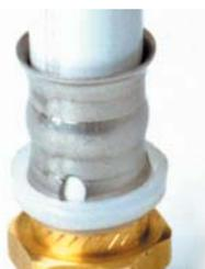
После опрессовки на поверхности пресс-гильзы фитинга остаются две уплотнительные канавки (бороздки) – следы от инструмента. При правильной опрессовке эти следы должны быть равномерными и сплошными по всей окружности.
