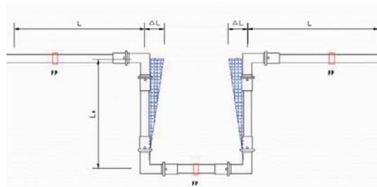
Компенсация теплового удлинения с помощью П-образного компенсатора при линейной прокладке трубопровода. Значение компенсационного плеча в соответствии с формулой или по диаграмме
