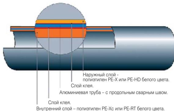
алюминиевого слоя 0,2 мм) более пластична и применяется в системах напольного отопления а также системах поверхностного отопления/охлаждения.
