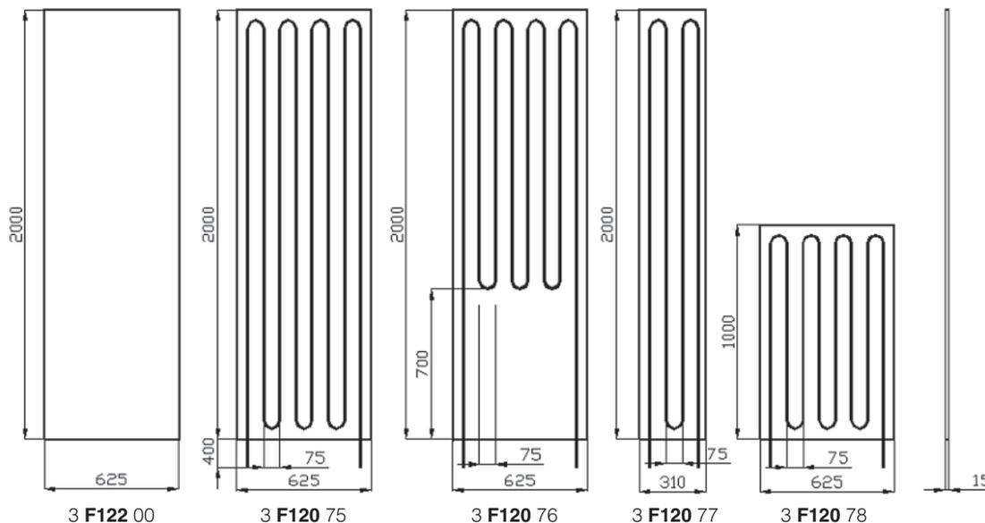
Панели изготовлены методом прессования, имеют острые кромки, обладают огнеупорными и влагонепроницаемыми свойствами, могут обрабатываться режущим инструментом (пила, нож). Металлополимерные трубы уложены заводским способом в профрезерованные в панелях трубные канавки.
