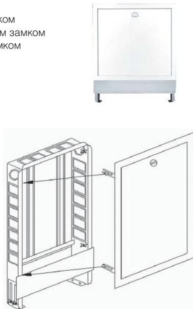
Ширина распределительного шкафа выбирается индивидуально в зависимости от применяемых распределителей и присоединительной арматуры.
