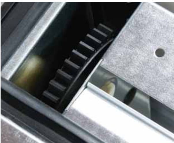
Для защиты от загрязнения шестерни вращения створок клапана отделены от потока воздуха.
