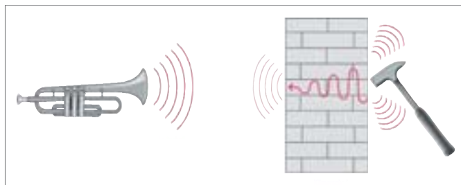
Рис. 3-2 Распространение шума по воздуху и через строительные конструкции
