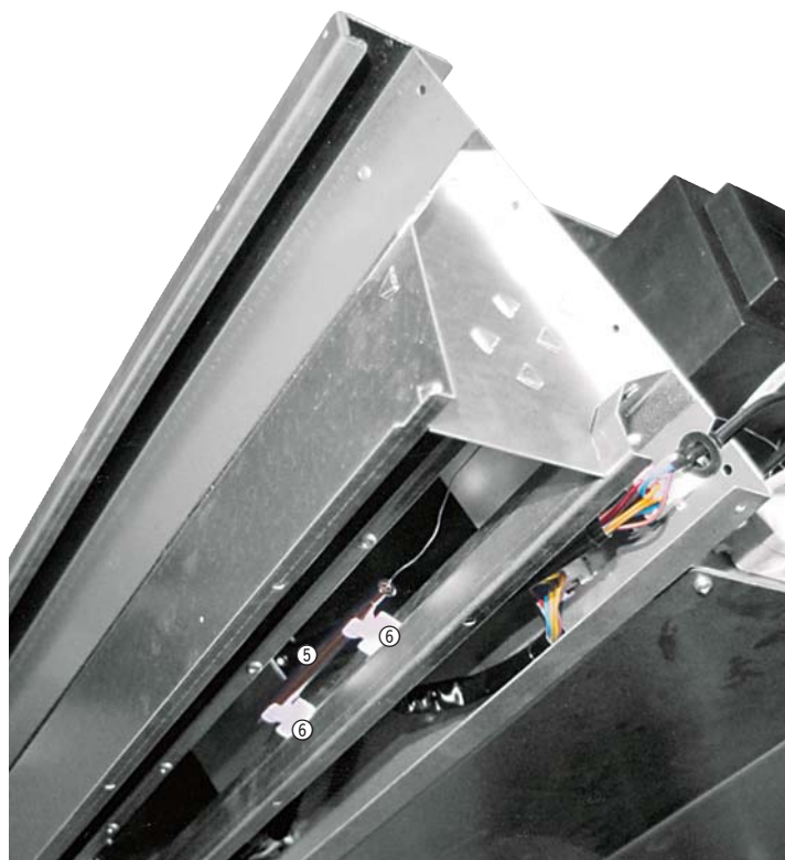
Монтаж датчика температуры воздуха на выходе
