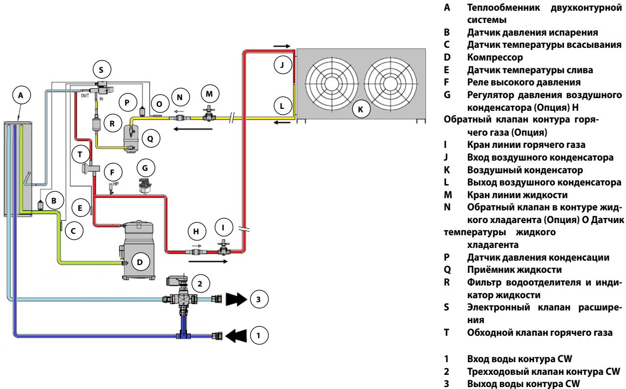
Холодильный контур кондиционера "Два источника CW/DX"
