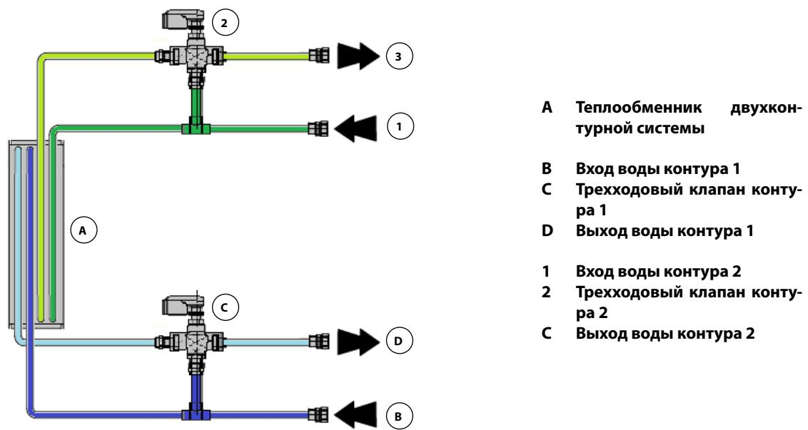
Холодильный контур кондиционера "Два источника CW/CW"
