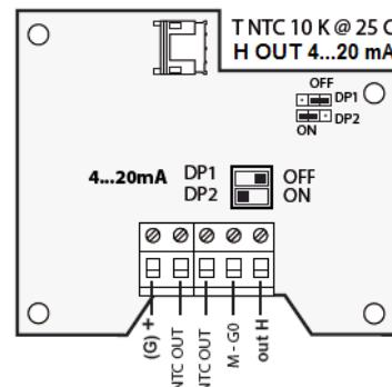
Подключение датчика и установка перемычки
