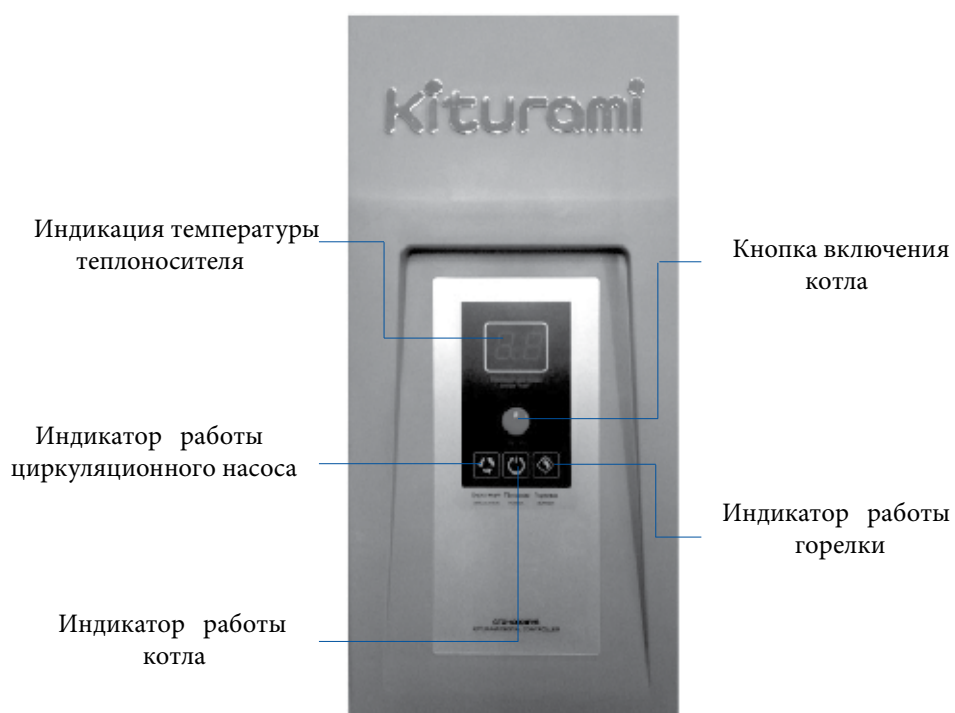
Рисунок 11. Блок управления KSO- 50/70/100/150
