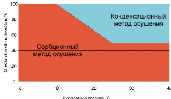
Рис. 4. Преимущественные области использования различных методов осушения
