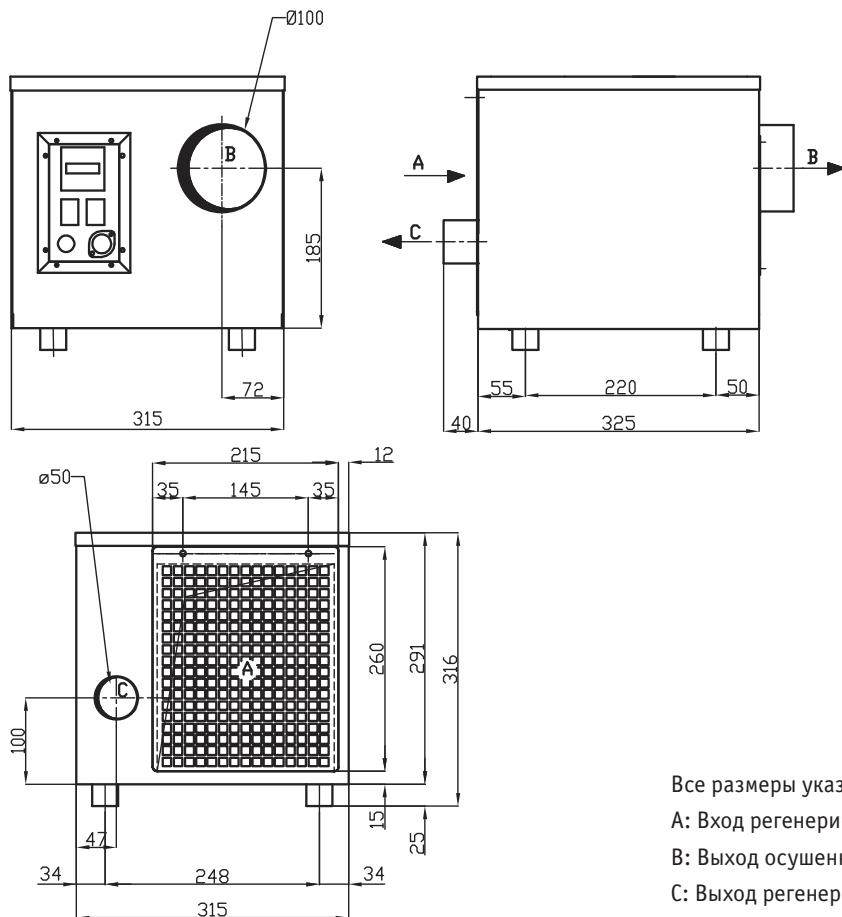
Рис. 13. Габаритный чертеж осушителя AD 120 B.
