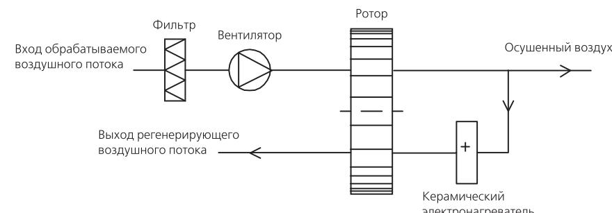
Рис. 8. Принципиальная схема осушителей AD 120...400 B.
