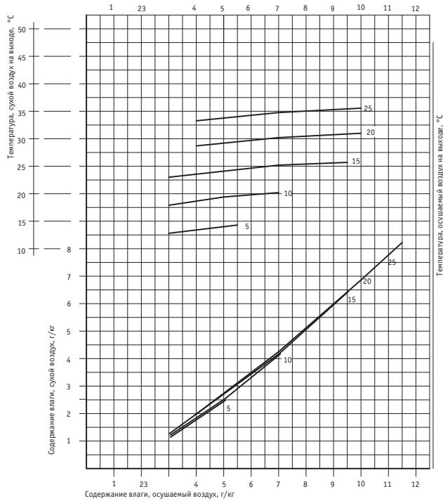
Приведенные кривые применимы для расхода регенерирующего воздуха 35 м<sup>3</sup>/ч и номинальному расходу обрабатываемого воздуха 120 м<sup>3</sup>/ч.
