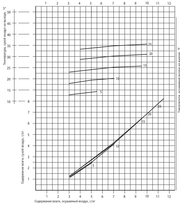
Приведенные кривые применимы для расхода регенерирующего воздуха 45 м<sup>3</sup>/ч (что соответствует показаниям амперметра 4 А) и номинального расхода обрабатываемого воздуха 240 м<sup>3</sup>/ч.
