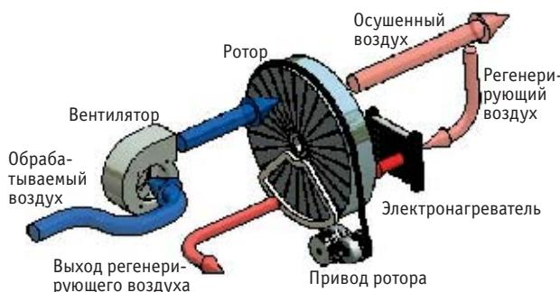
Рис. 7. Принцип действия осушителей AD 120...400 B.
