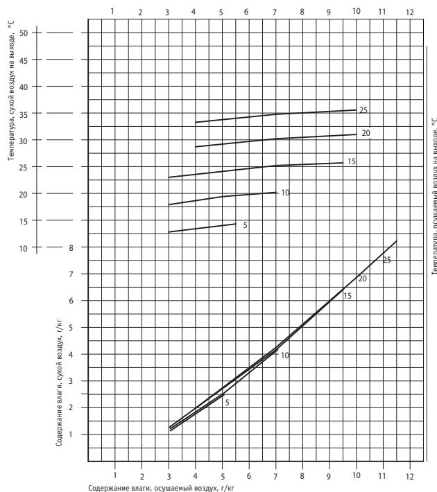
Приведенные кривые применимы для расхода регенерирующего воздуха 85 м<sup>3</sup>/ч (что соответствует показаниям амперметра 8 А) и номинального расхода обрабатываемого воздуха 400 м<sup>3</sup>/ч.
