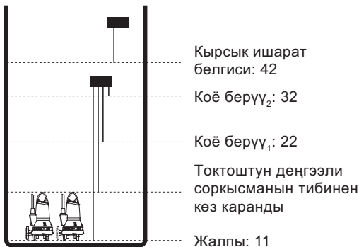
19-сүр. Эки соркысма менен жабдылган канализациялык кудуктагы электроддор.
