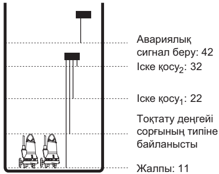
19-сур. Екі сорғымен жабдықталған кәріздік құдықтағы электродтар
