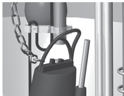
Рис. 15. Подъемная цепь, прикрепленная к насосу
