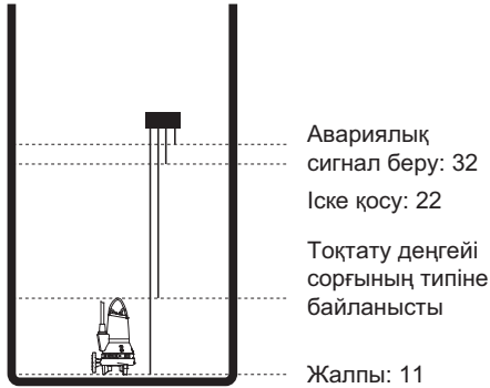
18-сур. Бір сорғымен жабдықталған кәріздік құдықтағы электродтар
