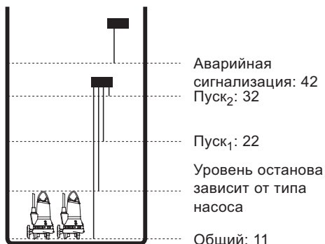
Рис. 19. Электроды в канализационном колодце, оборудованном двумя насосами
