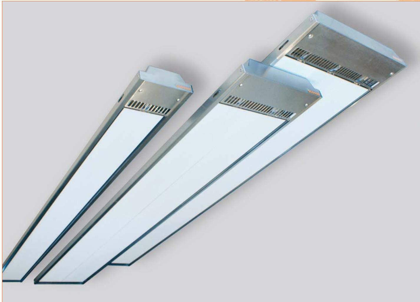
В высокотемпературных обогревателях ECOSUN источником ИК-излучения является стальной тен. Он расположен внутри алюминиевой пластины, покрытой специальным составом SILICATING для значительного повышения коэффициента излучения. Одна или несколько панелей (в зависимости от мощности обогревателя) установлены в корпусе из окрашенной стали. Номинальная мощность, благодаря применению технологии SILICATING составляет 8,76 кВт/м<sup>2</sup>. Максимальная температура нагрева панели — 350°C.
