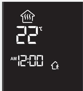
Режим отсутствие при отоплении по температуре теплоносителя.
