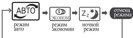
► Включаем автоматический режим отопления.
