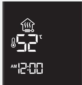
Температуру теплоносителя можно регулировать на промежутке 40–85 °C
