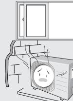
▶ Установите внешний блок таким образом, чтобы обеспечить надлежащий выброс воздуха наружу. Избегайте мест, где шум от работы кондиционера может причинить беспокойство соседям.
