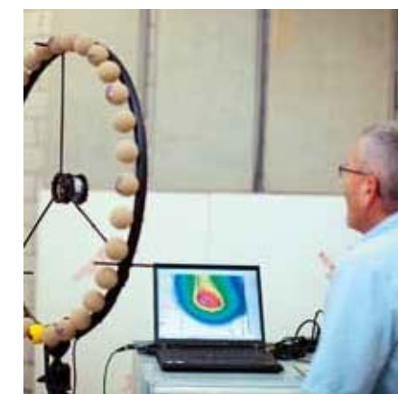
Источник шума может быть точно определен с помощью акустической камеры.
