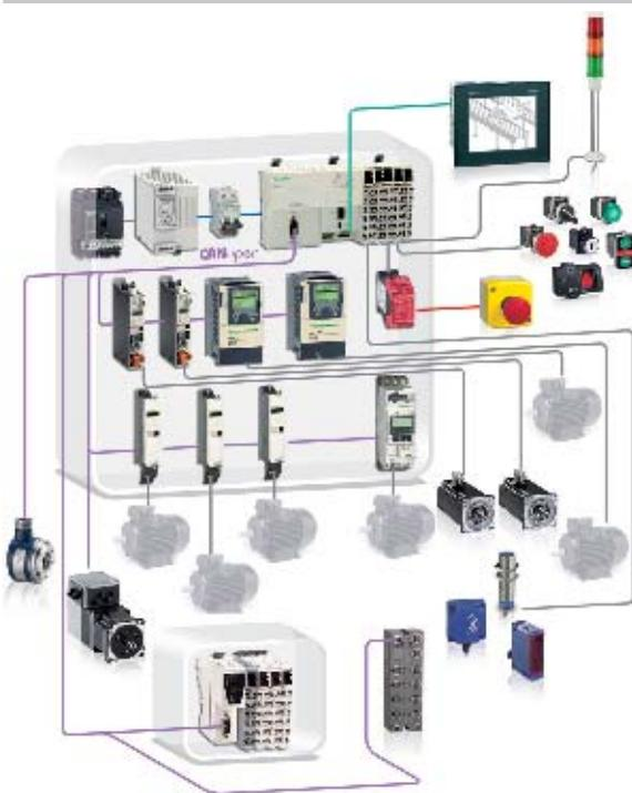
Пример с использованием контроллера перемещения Modicon LMC058
