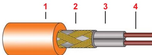
Экранированный нагревательный кабель с двойным покрытием и с внешней термостойкой оболочкой PVC.
